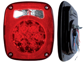
143P PLAF. CALAV. JP WRANGLER 91-08 LEDS GIRAT.-STROBO
